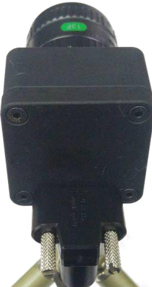
그림 10. Locking Pin 을 갖는 USB 3.0 케이블
