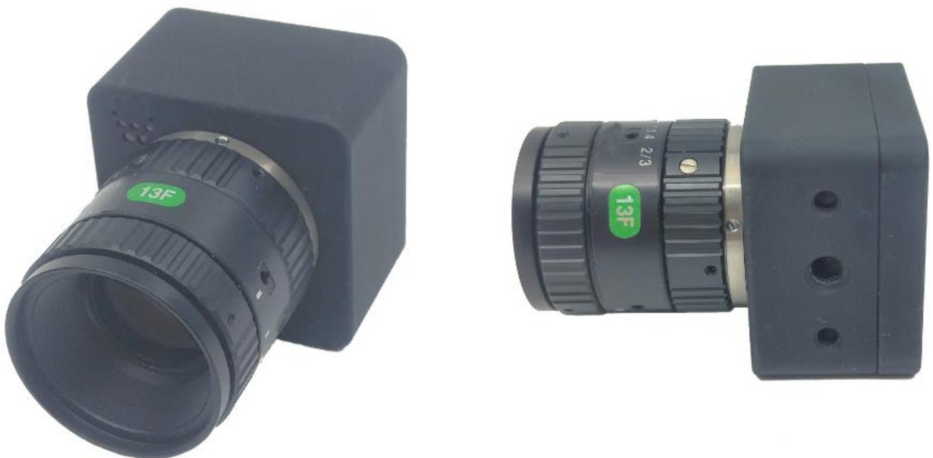
그림 4. oCam-18CRN-U 에 C Mount 렌즈를 장착한 모습 (예시 이미지)
